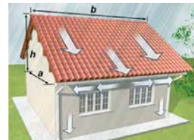
TELHADO COM 2 CONDUTORES
