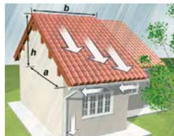
TELHADO COM 1 CONDUTOR
