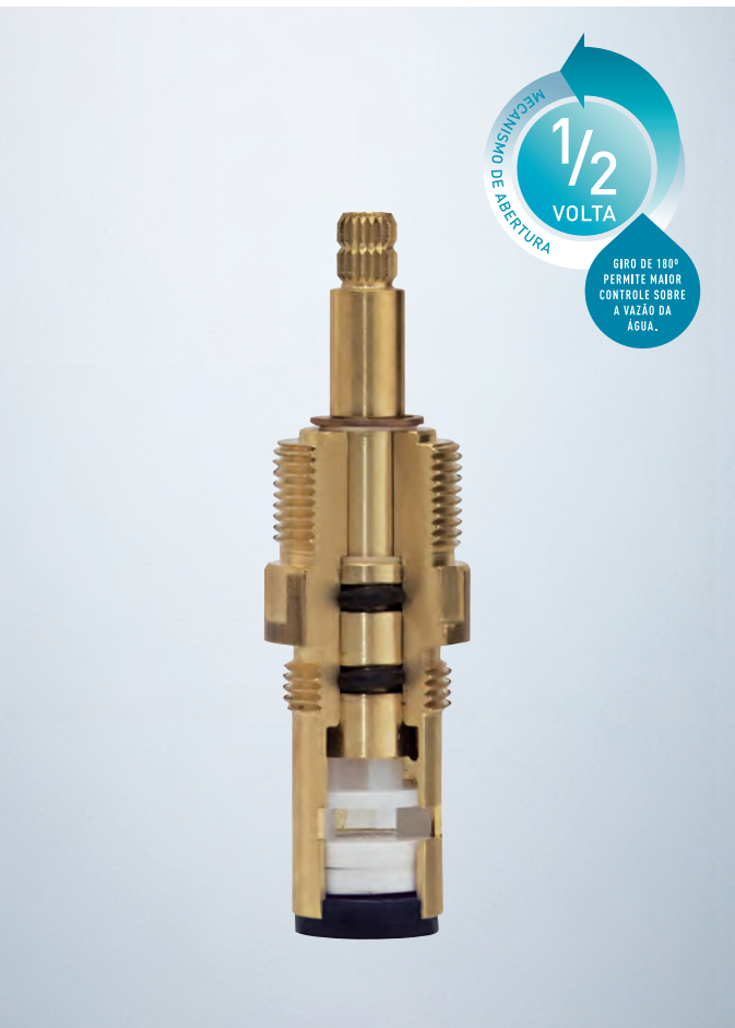
Cartucho DocolBase Cerâmico (DBC) 1/2 Volta em Corte
