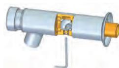
Torneira para Lavatório de Parede com RRV Embutido: regulação da vazão com auxílio da chave sextavada.
