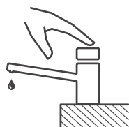
Orientação de Funcionamento Abertura com Leve Pressão Manual e Fechamento Automático
