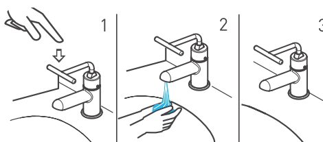
Orientação de Funcionamento Abertura com Leve Pressão Manual e Fechamento Automático
