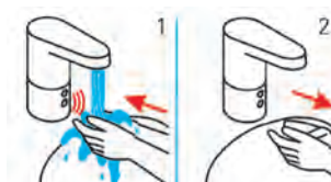
Orientação de Funcionamento Abertura e Fechamento Automáticos
