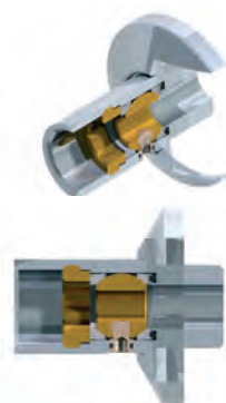
Registro Regulador de Vazão em Corte
