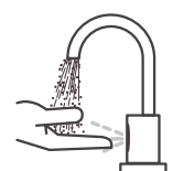
Orientação de Funcionamento Abertura e Fechamento Automáticos
