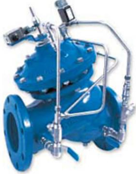
A Válvula Controladora de Bomba Modelo 740 é uma válvula de retenção ativa operada hidraulicamente, acionada por diafragma que abre e fecha completamente em resposta a sinais elétricos. Essa válvula isola a bomba do sistema durante a partida e a parada da bomba, para evitar os golpes de arfete na tubulação.
