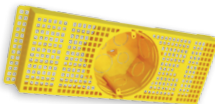
CX4L/S30 Caixa de luz em PVC com suporte em PP para lajes pré-fabricadas. Para vãos entre vigas de 30 cm. 32,9 x 11,2 x 6,1 cm. Não propaga chamas. Ø 10,5 x 5,5 cm
