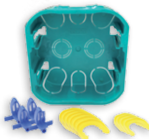
CX44/DW Indicada para dry wall (parede seca). Possibilita a utilização de conduítes de 1/2" ou de 3/4". Acompanha: 6 travas de 3/4 (DN25), 4 travas de 1/2 (DN20) e 4 pinos. 11,2 x 10,9 x 4,8 cm.
