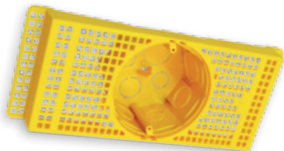
CX4L/S25 Caixa de luz em PVC com suporte em PP para lajes pré-fabricadas. Para vãos entre vigas de 25 cm. 27,9 x 11,2 x 6,1 cm. Não propaga chamas. Ø 10,5 x 5,5 cm
