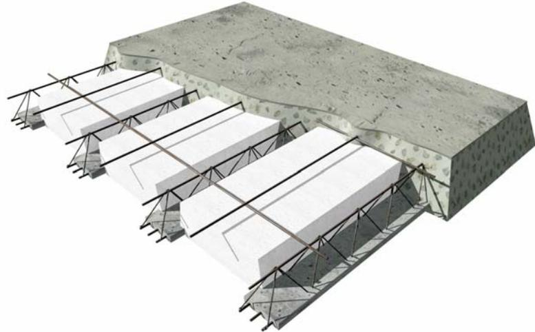
**Laje Trelçada Com EPS:** Composta por vigotas trelçadas (armação trelçada com base de concreto) e elementos inertes EPS (Isopor®), montados intercaladamente.
