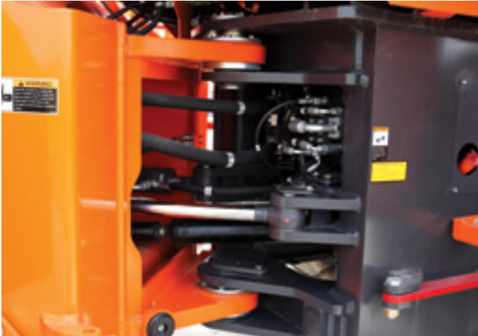
Juntas Centrais Para facilitar a manutenção é essencial um bom acesso à junta de articulação.
