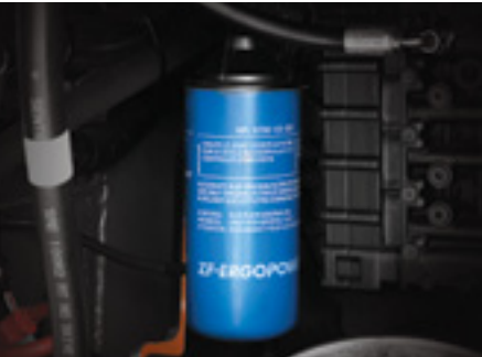
Filtro da Transmissão Os filtros da transmissão são de fácil acesso e como todos os demais componentes de manutenção da máquina, podem ser verificados do nível do chão.
