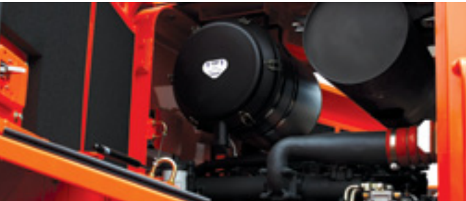
Filtro de Ar O filtro de ar de alta capacidade elimina as partículas indesejáveis do ar, ampliando a vida do motor e os intervalos de troca.
