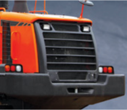
Grade do Radiador (Estrutura em Aço)
