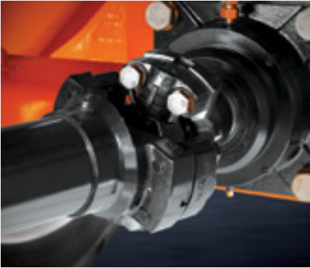
Eixo Propulsor Foi instalada uma capa de proteção para proteger a vedação do óleo contra poeira, objetos estranhos e desgaste prematuro.
