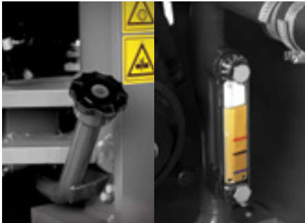
Abastecimento Conveniente de Óleo da Transmissão Como o medidor de nível do óleo da transmissão está fixado no tubo do bocal de óleo, é fácil verificar o nível visualmente enquanto se abastece. Além disso, o tubo do bocal de óleo se encontra perto da junta de articulação para fácil acesso.
