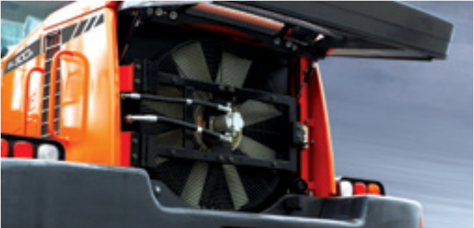
Ventilador Hidráulico O ventilador hidráulico pode ser girado para fora e é muito fácil de limpar os núcleos do arrefecedor. O condensador do ar-condicionado está combinado como conjunto do radiador e pode ser basculado para facilitar a limpeza.
