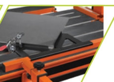
Grampos para fixação da peça obra
