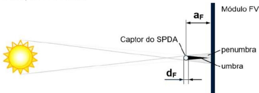
De forma resumida, esse efeito pode causar desde a diminuição na produção de energia até danos severos aos módulos. Por isso, é fundamental que nos projetos e instalações de SPDA para SFV's, as distâncias de sombreamento sejam respeitadas pelos captores durante todo o período do dia e levem em consideração as estações do ano.
