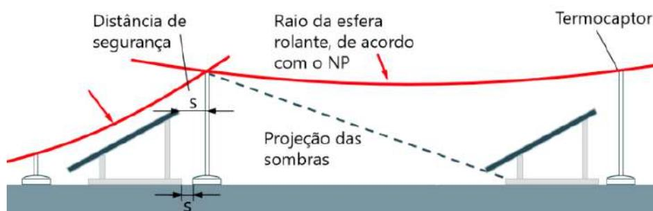
A fórmula para calcular o afastamento mínimo ( $a_f$ ) de um captor com diâmetro ( $d_f$ ) de um módulo fotovoltaico é:
