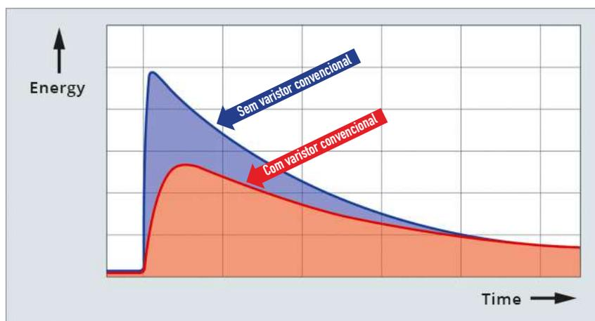
Quando o protetor instalado é construído a partir de varistores, a parcela de surto que flui por ele é baixa e consequentemente uma maior energia chega aos terminais do equipamento. Isso pode representar danos ou uma degradação precoce, que reduz consideravelmente sua vida útil.
